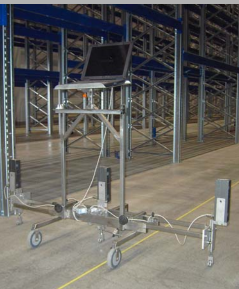
Bild 3: Der Messwagen erfasst digital die Höhendaten der 3 Fahrspuren
