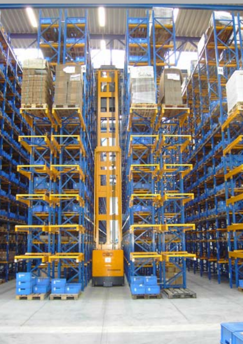
Bild 2: Leitliniengeführter Schmalgangstapler erfordert besondere Eigenschaften des Industriebodens
