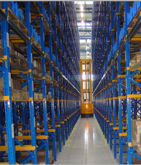
Bild 1: Böden in Schmalgängen von Hochregallagern sind stark beansprucht
